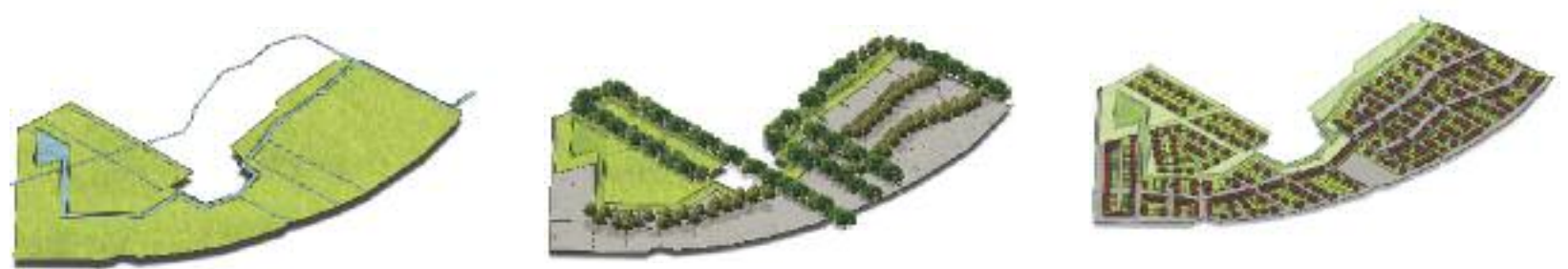
De principes van het stedenbouwkundig plan voor Vathorst Velden 3DEF: waterstructuur, houtwallen en bebouwing.
